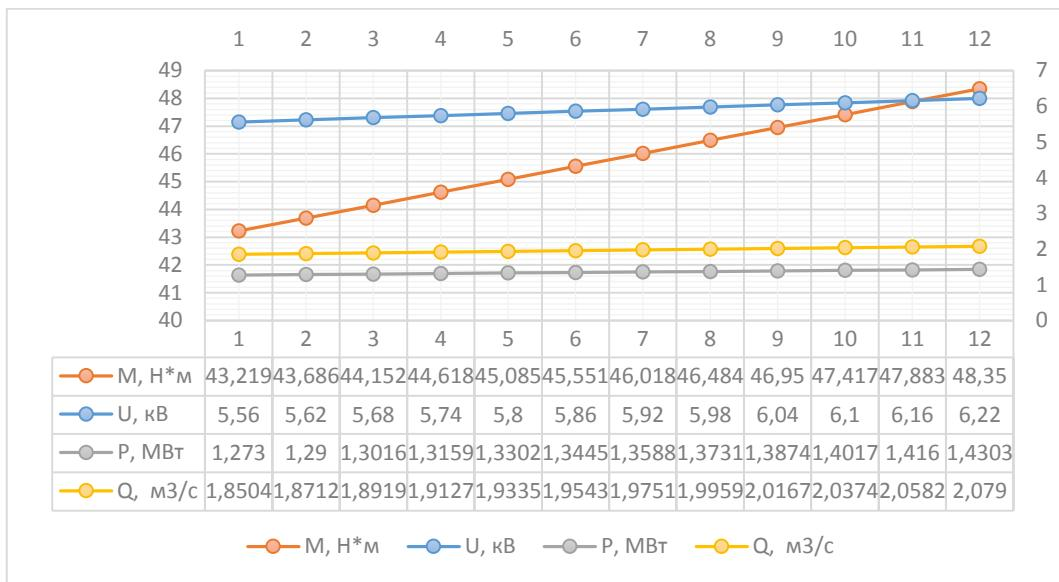
Рис. 1. Производительность насосной станции при снижении напряжения от 1 до 10%
