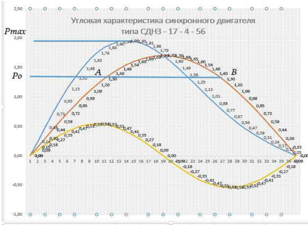
Рис. 2. Угловая характеристика синхронного двигателя
